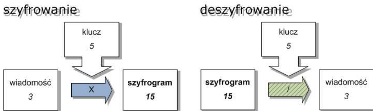
Rys. 1. Szyfrowanie i deszyfrowanie w kryptografii symetrycznej; liczby poniżej podpisów w dużym uproszczeniu obrazują wykonywane operacje.
